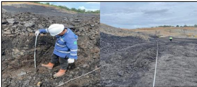
Gambar 5 Pengukuran kedalaman 1513atubara dan 1513atubar chanel.
