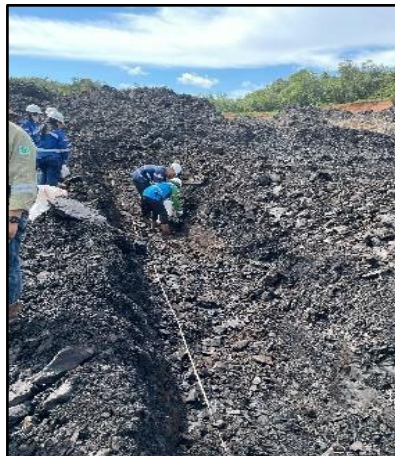
Gambar 1. Channel Sampling pada Batubara
