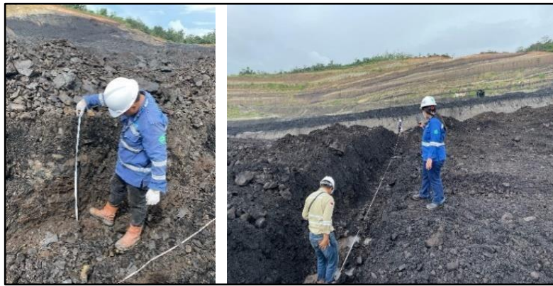
Gambar 2. Pengukuran pada Channel (a) Pengukuran kedalaman (b) Pengukuran Panjang Sumber: Penulis, 2025
