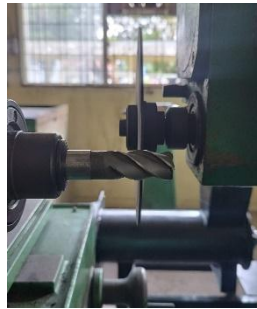
Gambar 8. Meratakan Permukaan End Mill Cutter
