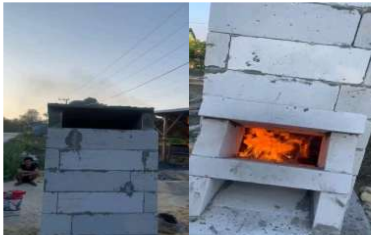
Gambar 2. Uji coba Rocket Stove dalam proses pembakaran sampah
