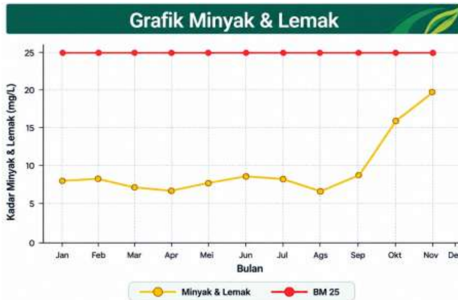
Gambar 4. Tren Minyak dan Lemak Effluent Outlet Kolam 06 Tahun 2025
